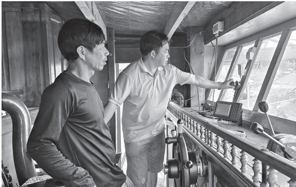
Lắp đặt máy lái tự động trên tàu cá QT 90109TS của ông Trần Văn Hải
