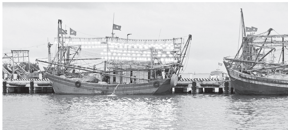
Hệ thống đèn LED hiện đại được lắp đặt trên tàu cá giúp tiết kiệm nhiên liệu tiêu thụ cho chiếu sáng so với đèn halogen truyền thống
